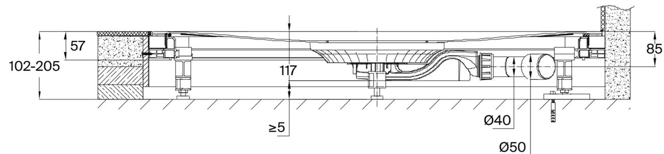
Representación del sistema de instalación universal con desagüe BetteAir 30\* - 0,6 l/s, con drenaje en el lateral y profundidad del sello de agua de 30 mm
