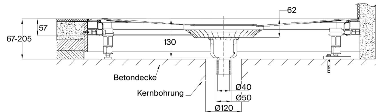
Representación del sistema de instalación universal con desagüe BetteAir Down 0,6 l/s, con drenaje vertical y profundidad del sello de agua 50 mm
