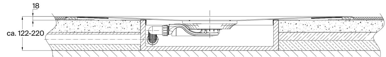
Representación del registro BetteAir con desagüe BetteAir 30\* - 0,6 l/s, con drenaje en el lateral y profundidad del sello de agua de 30 mm
