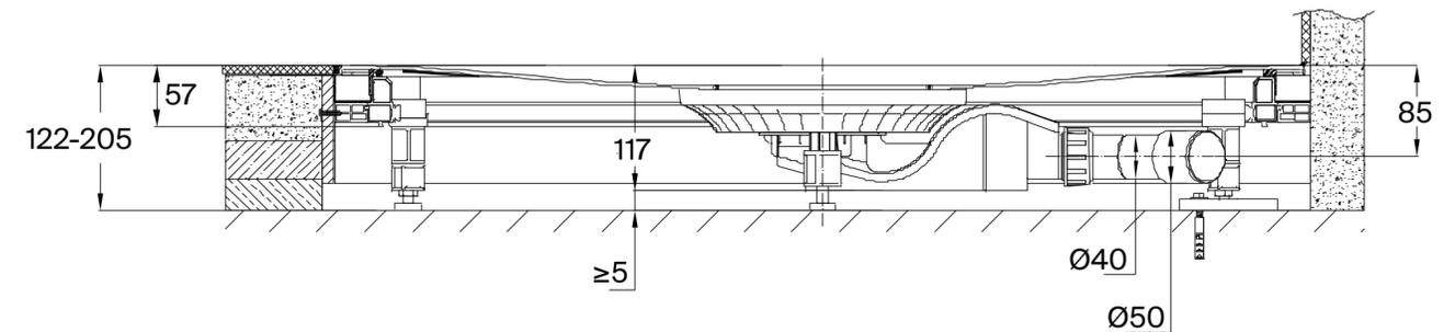
Representación del sistema de instalación universal con desagüe BetteAir 50 - 0,6 l/s, con drenaje en el lateral, profundidad del sello de agua conforme a normativa de 50 mm según EN 274
