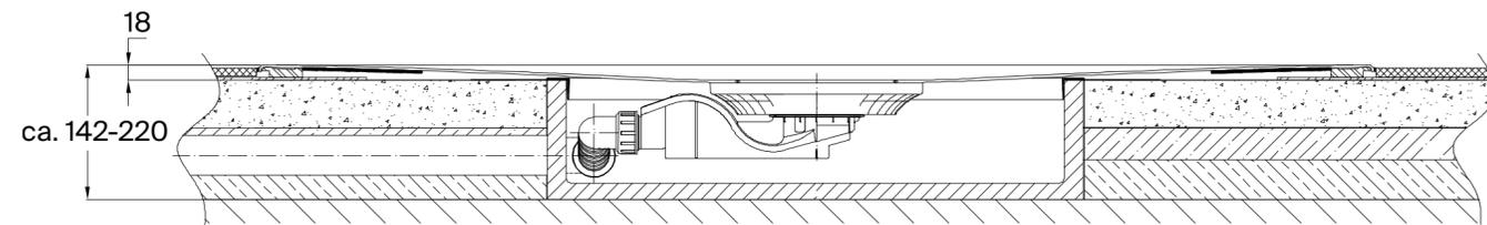
Representación del registro BetteAir con desagüe BetteAir 50 - 0,6 l/s, con drenaje en el lateral, profundidad del sello de agua conforme a normativa de 50 mm según EN 274
