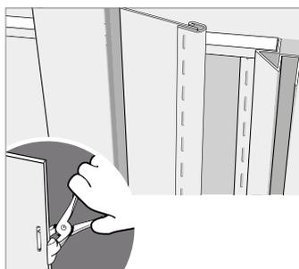
14- Si es necesario, corte el siding a la medida exacta para llegar a la esquina o rincón, agregue muescas cada 40 cm, e inserte el perfil Término.
