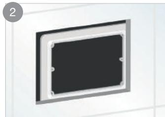
2 Introduzca la base de la celosía, dentro del shaft, haciéndola coincidir con la perforación del ducto de ventilación.
