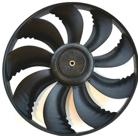
Las unidades 30KAV/30KAVP utilizan la sexta generación de tecnología de ventiladores Flying Bird™ de Carrier, diseñada para una eficiencia máxima, un nivel acústico superbajo y un amplio rango operativo. El ventilador incluye la tecnología patentada de envolvente giratoria y palas con barrido hacia atrás de Carrier y un borde inferior ondulado con dientes inspirado en diseños bionaturales.
