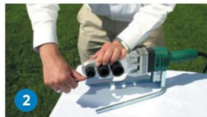
2 Equipar la máquina con las herramientas adecuadas y limpiar sus boquillas. Enchufarla y finalmente encenderla. Cuando se apaga la luz de control la temperatura de termofusión (260°C + - ) fue alcanzada.
