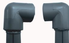
El anillo que se forma entre el fitting y la tubería nos indica a simple vista que la termofusión fue hecha incorrectamente.
