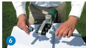
6 Inserte simultáneamente el tubo y el accesorio en las boquillas correspondientes.
