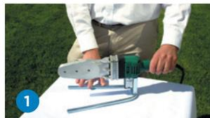
1 Posicionar la máquina de termofusión de la forma que resulte más cómoda y segura de operar, y chequearla.
