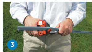
3 Corte el tubo en logitud requerida.
