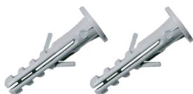
**Tarugos:** Se introduce en una perforación hecha en ladrillo o concreto y a la entrada del tornillo en la parte superior empuja las paredes del tarugo y comprime el plástico dentro del hueco ejerciendo presión.
