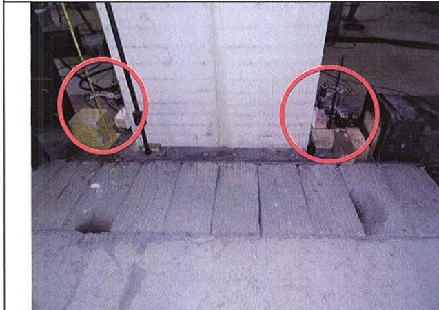
**Fotografía 3.2.5:** Detalle de los transductores dispuestos para medir el giro de la probeta durante el ensayo.
