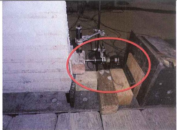
**Fotografía 3.2.6:** Detalle del transductor utilizado para medir el posible corrimiento del panel y del tope inferior.
