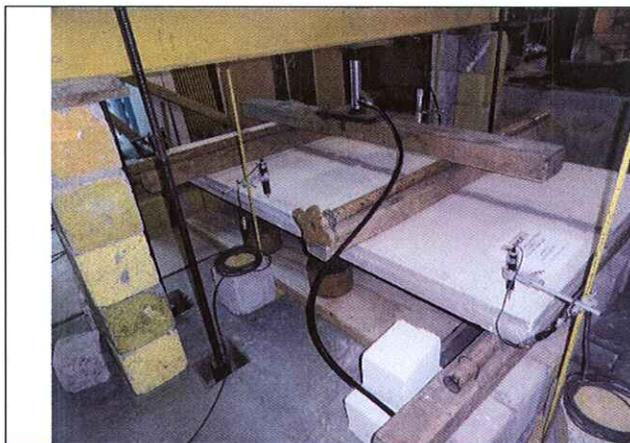
**Fotografía 3.3.1:** Vista general de la implementación y del panel sometido al ensayo de carga transversal (Flexión).
