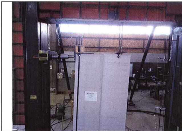
**Fotografía 3.2.1:** Vista general de la implementación y del panel sometido al ensayo de carga horizontal (Corte).
