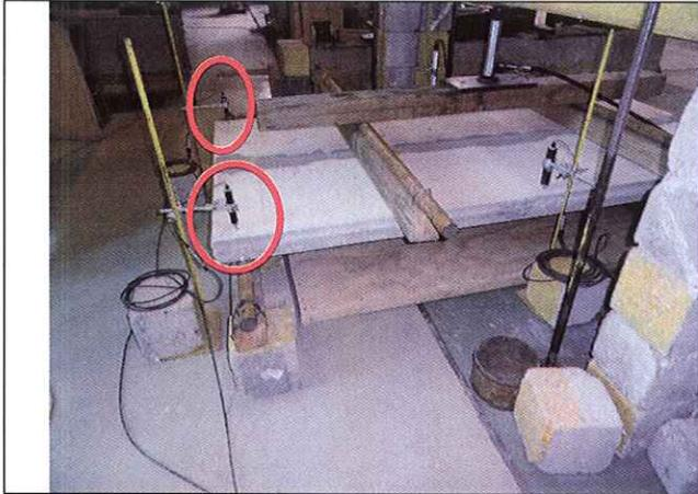
**Fotografía 3.3.3:** Detalle de dos de los cuatro transductores dispuestos para medir la deformación en el sector de los apoyos de la probeta durante el ensayo.
