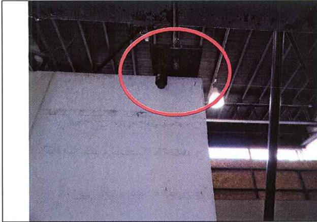
**Fotografía 3.2.3:** Detalle de los rodillos dispuestos para evitar desplazamientos laterales durante el ensayo.
