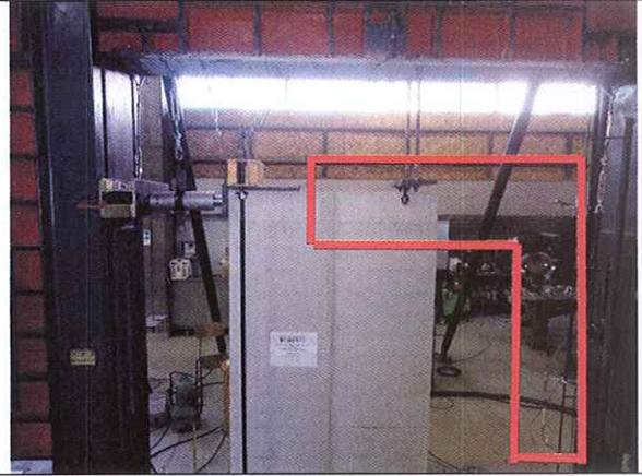
**Fotografía 3.2.4:** Detalle del transductor utilizado para medir la deformación horizontal total durante el ensayo.
