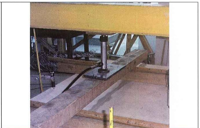
**Fotografía 3.3.2:** Detalle del sistema de aplicación y repartición de la carga (1 gato hidráulico y vigas de repartición).
