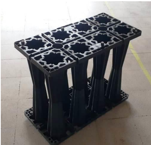
Foto N° 1: Detalle de celda de drenaje sin refuerzos laterales
