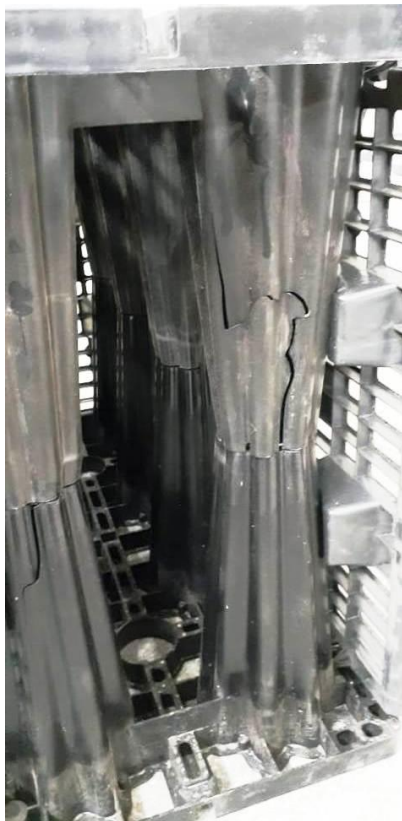
Foto N° 3: Detalle del tipo de falla en celda de drenaje sin confinar
