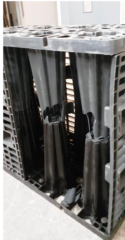
Foto N° 4: Detalle del tipo de falla en celda de drenaje confinada
