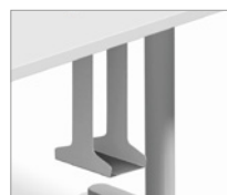
Soporte metálico anclado al larguero
