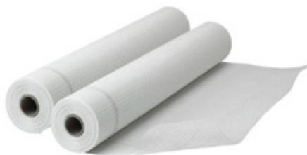
Malla de fibra de vidrio 1m x 50m2 especial para reforzar el poliestireno del sistema EIFS. tiene diversas propiedades: es ignífuga, soporta grandes temperaturas, provee excelente aislamiento térmico, es inerte incluso a los ácidos, y resistente a las roturas alca.
