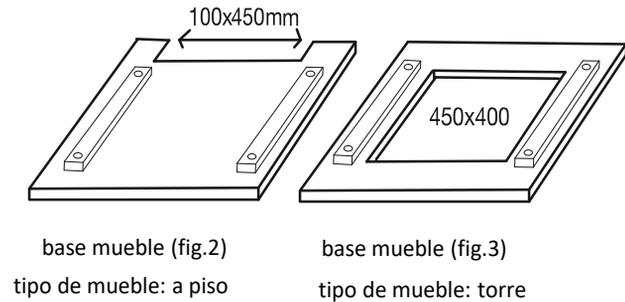
Además, el horno debe estar apoyado en una superficie plana con una abertura de al menos 100x450mm en la parte trasera (fig.2), o bien una perforación en el centro de 450x400mm (fig.3) dependiendo de la naturaleza de su mueble.
