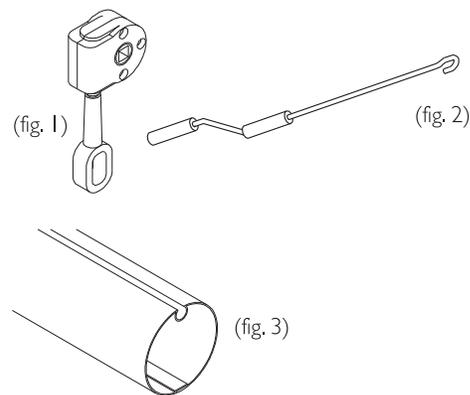
**Operación:** Los toldos se pueden operar en forma manual por medio de un torno reductor ( fig.1 ) ubicado en uno de los extremos del toldo, accionado por una manivela ( fig.2 ).
