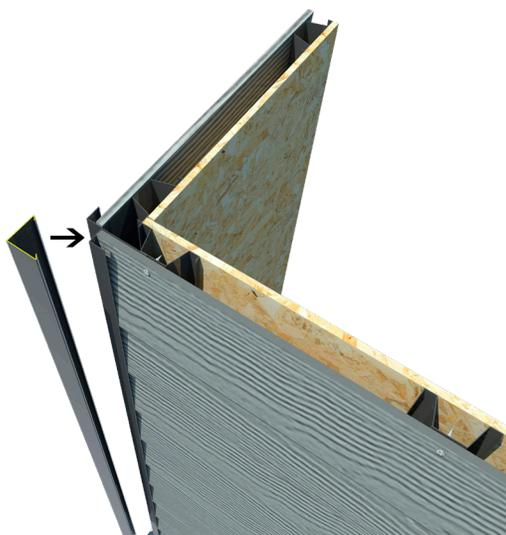
5.2 En caso de que la última hilera de tablas quede a la intemperie, debe disponerse un cierre que se puede ejecutar con el perfil J o una pieza galvanizada en forma de L.
