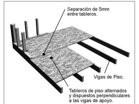
Para techos y pisos, las cargas máximas recomendadas para tableros instalados perpendiculares a los apoyos.
