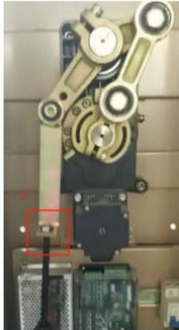
**Paso 2:** Utilice una llave de tubo para quitar el brazo de conexión. Desatornille los tornillos en ambos extremos, afloje el brazo de conexión (la arandela detrás de los tornillos debe ser segura), como se muestra en la figura:
