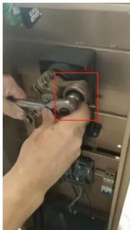
**Paso 3:** Retire el brazo de conexión del resorte (la arandela detrás del tornillo debe ser segura), como se muestra en la figura:
