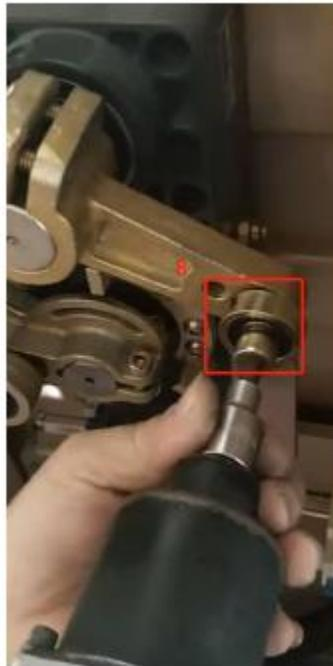
**Paso 9:** Reemplace el resorte a la derecha, luego conéctelo al brazo de conexión del resorte e instálelo, como se muestra en la figura:
