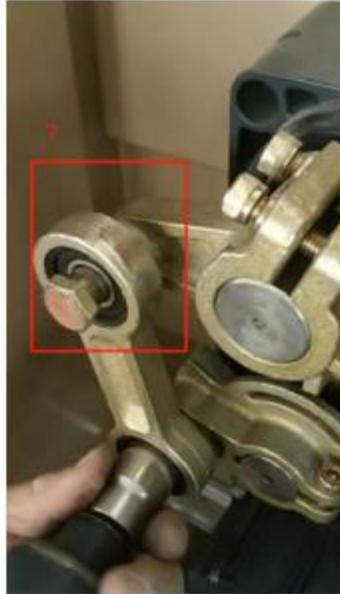
**Paso 8:** Conecte e instale el brazo de conexión del resorte con el brazo de conexión del eje (la junta en la parte posterior del tornillo debe ser segura), como se muestra en la figura:
