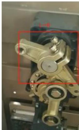
**Paso 6:** Retire los 4 tornillos del bloque mecánico de limite, mueva el bloque limitador a la posición simétrica correcta, y luego apriete los tornillos:
