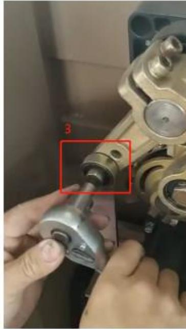
**Paso 4:** Afloje los 2 tornillos del brazo de conexión del eje y saque el balancín, como se muestra en la figura:
