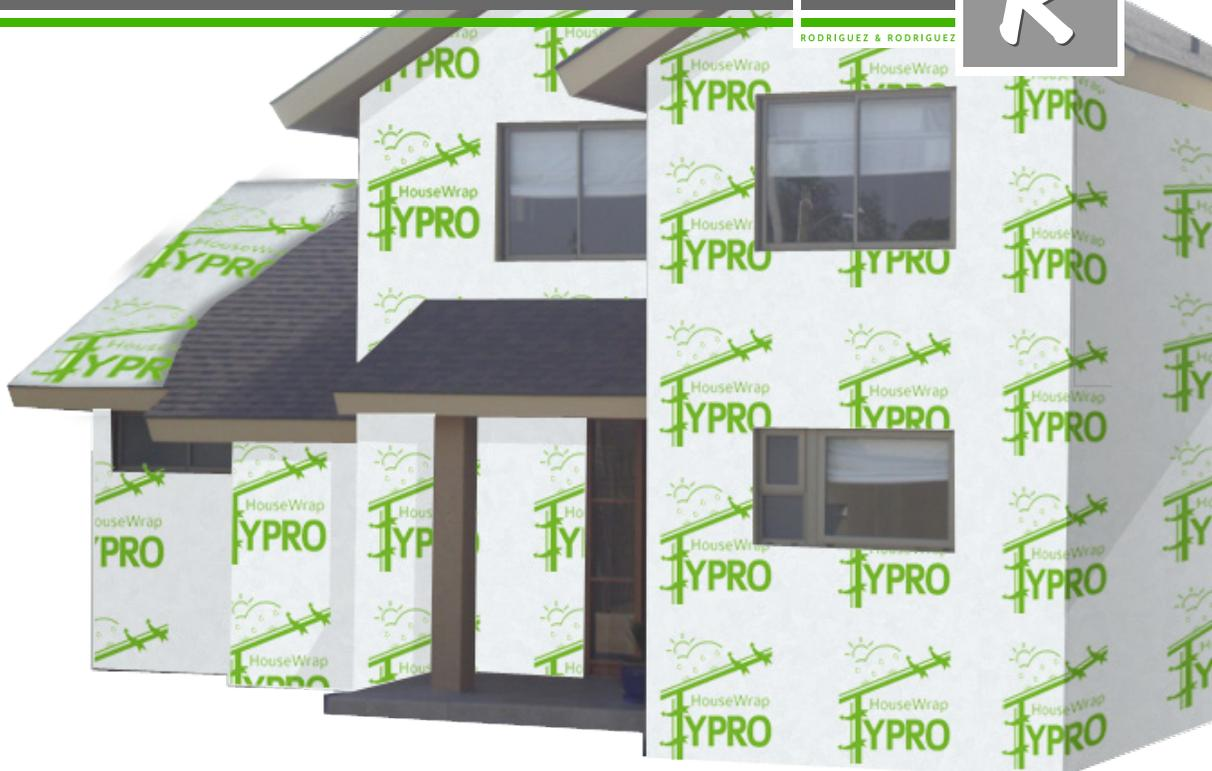
**LÁMINA DE ENVOLTURA** UTILIZADA EN MUROS VERTICALES O TECHUMBRES, PARA ASEGURAR LA ESTANQUEIDAD DEL AIRE INTERIOR. PREVIENE INFILTRACIONES DE AIRE, DEJANDO SALIR EL VAPOR DE AGUA, EVITANDO LA ACUMULACIÓN DE ESTA DENTRO DE LAS SOLUCIONES CONSTRUCTIVAS, **ALARGANDO LA VIDA DE LOS MATERIALES** Y EVITANDO PATOLOGÍAS ASOCIADAS EN LA EDIFICACIÓN.
