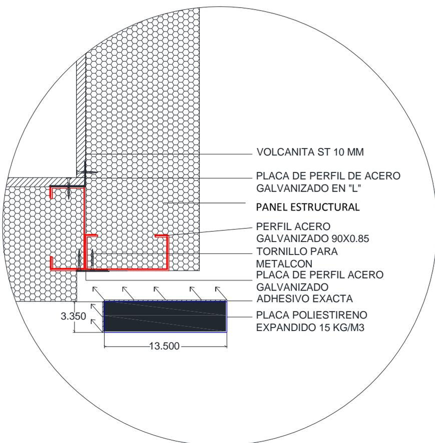
En zonas donde el perfil del Panel estructural **EXACTA®** quede expuesto hacia el exterior se recomienda pegar en conjunto al adhesivo Exacta una placa de poliestireno expandido de alta densidad (30 kg/m<sup>3</sup>) para evitar puentes térmicos.
