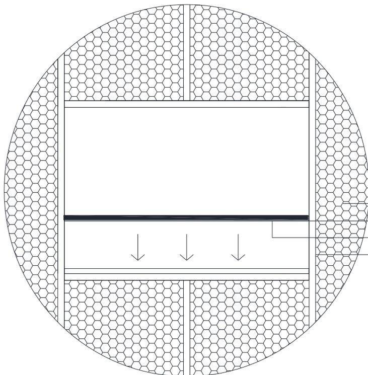
En zonas donde el perfil del Panel estructural **EXACTA®** quede expuesto en antepechos, dinteles y piernas de puertas y ventanas, se recomienda utilizar el Alfeizar Exacta en conjunto con el adhesivo **EXACTA®** para evitar puentes térmicos.
