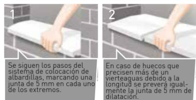
Se siguen los pasos del sistema de colocación de albardillas, marcando una junta de 5 mm en cada uno de los extremos.
