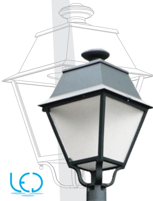
La luminaria **SEVILLA** está disponible potencias que varían entre **70W** y **150W** con fuente de descarga de **Haluros Metálicos Cerámicos** o **Sodio de Alta presión**; o **LED** en potencias variables hasta **70W** con diferentes distribuciones fotométricas. Esta luminaria puede ser montada como cabezal de poste, colgante o sobre brazos con toma vertical.
