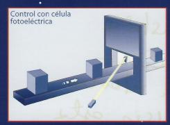
Una o varias células fotoeléctricas dispuestas diagonalmente, controlan la zona de cierre. En caso de aviso de vacío se para el sistema de transporte.
