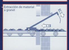
Un rastrillo accionado por energía almacenada gira en el sentido del proceso de transporte y arrastra el material de transporte.
