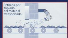
Es posible retirar materiales de transporte ligeros fuera de la zona de cierre por soplado mediante el uso de aire comprimido almacenado.
