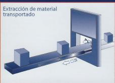
Los elementos transportados que se mueven sobre el sistema de transporte dejando espacios entre si, pueden ser retirados de la zona de cierre con una palanca de retroceso con movimiento de giro con energía neumática almacenada.
