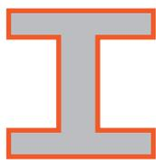
Estructura Metálica con Intumescente (en estado pasivo)
