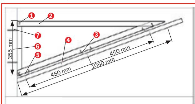
En la franja inclinada, la placa va en sentido longitudinal. El lado de 1 metro apoya sobre la pared.
