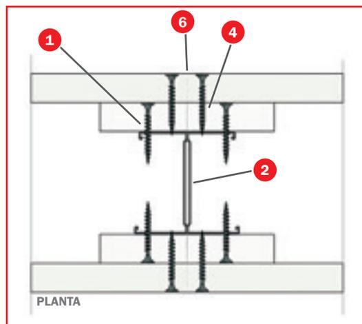
Para finalizar cubrir las juntas entre los paneles y las cabezas de los tornillos con **pasta de juntas Tecbor®**.
