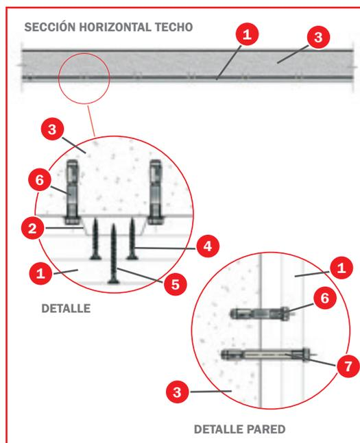
La protección de las paredes se realiza mediante dos paneles de **Tecbor**® 20 mm ancladas directamente sobre el hormigón. Para fijar la primera capa, utilizar anclajes metálicos 8x46 mm. Para la segunda capa, utilizar anclajes metálicos 8x76 mm M6.
