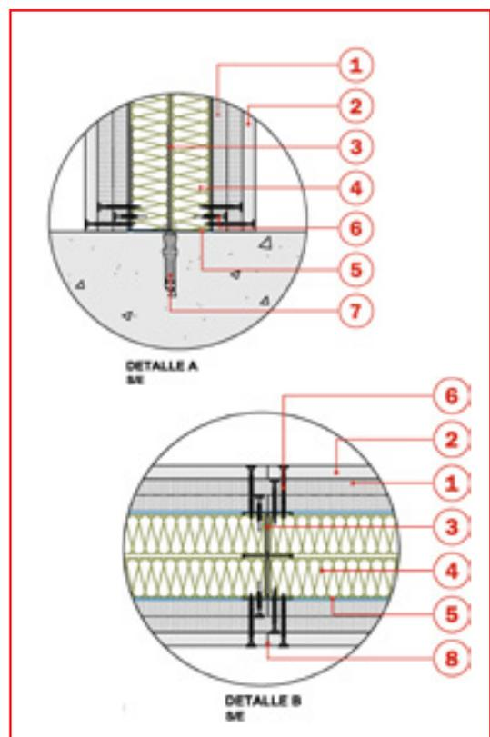
Aplicar **Pasta de juntas Tecbor®** o **Pasta de Agarre Tecbor®** en las uniones entre paneles y en las cabezas de los tornillos.
