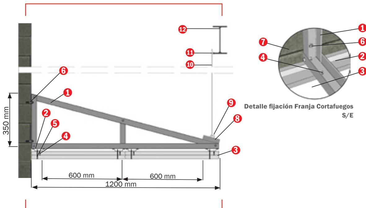
Sistema de montaje de la **franja inclinada**
