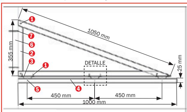
Sistema de montaje de la **franja inclinada**
