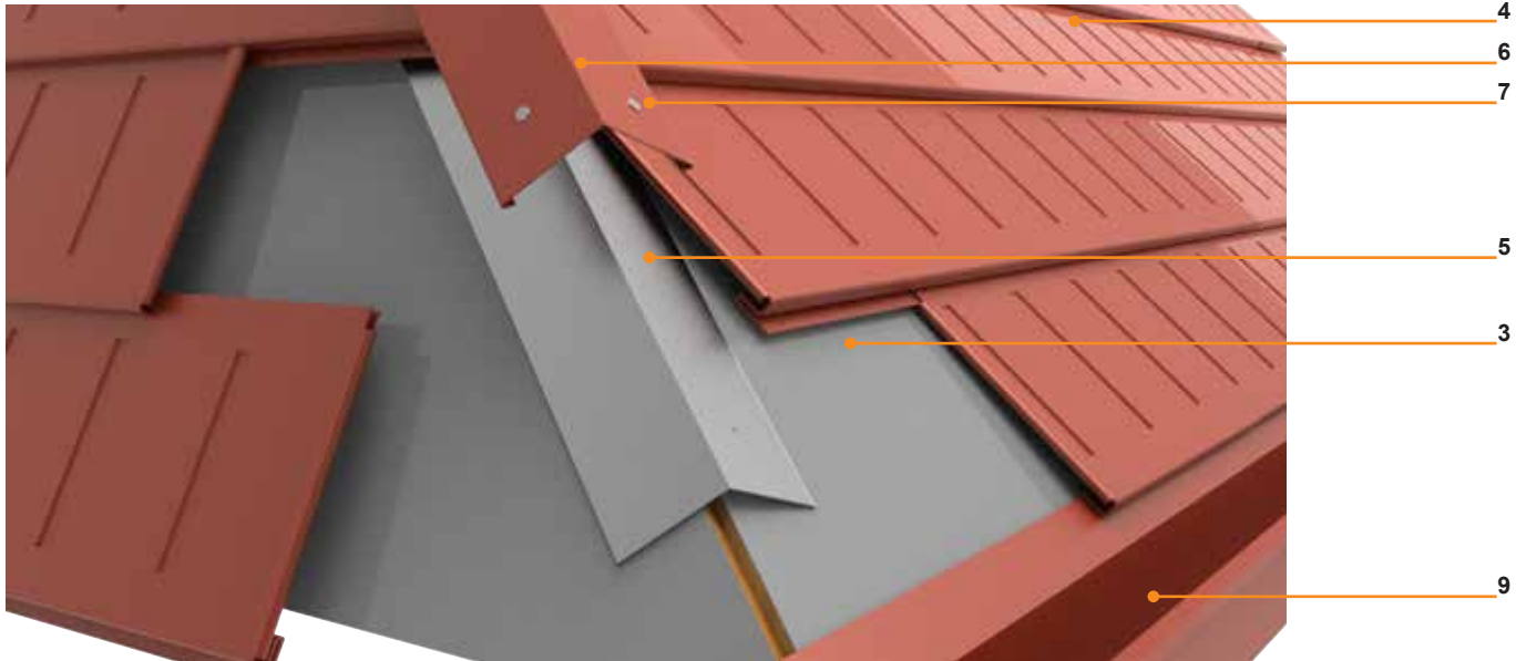
Vista detalle limahoya
