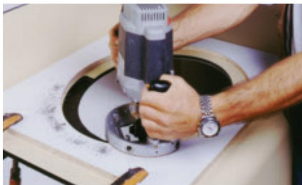
2. Rebaje la cara inferior del elemento Compactforming, mediante fresadora cilíndrica o centro de mecanizado CNC.
