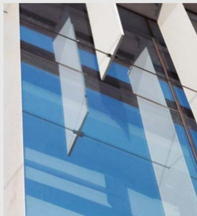
El cortasol Flat 25 - 50 es un producto metálico apropiado para ser utilizado en fachadas de forma horizontal o vertical. Está compuesto por paneles de geometría rectangular y debido a su composición, que incluye en su interior celdillas estructurales de aluminio (honeycomb) proporciona una inmejorable planitud a sus caras externas y una rigidez estructural asombrosa permitiendo distancias de apoyo solo en sus extremos.
