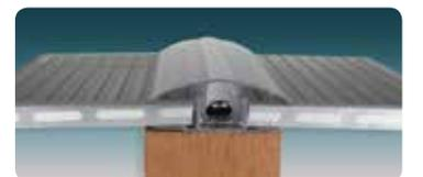
**6** Cubrir las cintas con los perfiles U ya sean de policarbonato o de aluminio. Estos perfiles deben permitir la ventilación de lámina, por lo que no debe quedar pegado al borde de la lámina y debe tener perforaciones en la parte inferior para permitir el escurrimiento del agua que pueda acumularse.
