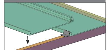
Verifique la medida final y corte la lámina para que pueda ensamblar en el perfil de remate final.
