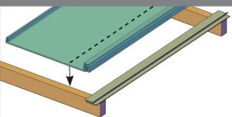
Instale la platina de aluminio en cada apoyo para asegurar la lámina, fije con tornillo.
