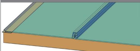
Corte la U de la sección inicial e instale la segunda U de PC completa según diseño.
