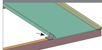
Ensamble la siguiente lámina haciendo clip y repita el paso anterior hasta completar el espacio.
