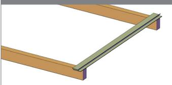
Corte un costado de la lámina y ensambleen el perfil de remate.
