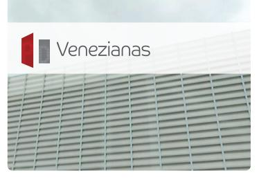
El sistema consiste en módulos de hasta 1.2mt de ancho, de Venezianas a lo largo de dos montantes metálicos en U. Las aletas poseen plegados en ambos lados, facilitando su adecuación a cualquier montaje. Posee protección UV en ambas caras.
